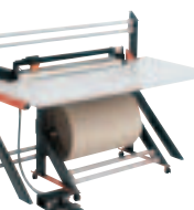
Pneumatik-Anbau-Schneidvorrichtung für Hinterkante an Tisch 2000 oder 5000, Klemmvorrichtung 20 bis 40 mm, Luftdruckanschluß 6 bar (max.), dazu passend Abrollbock (5)
