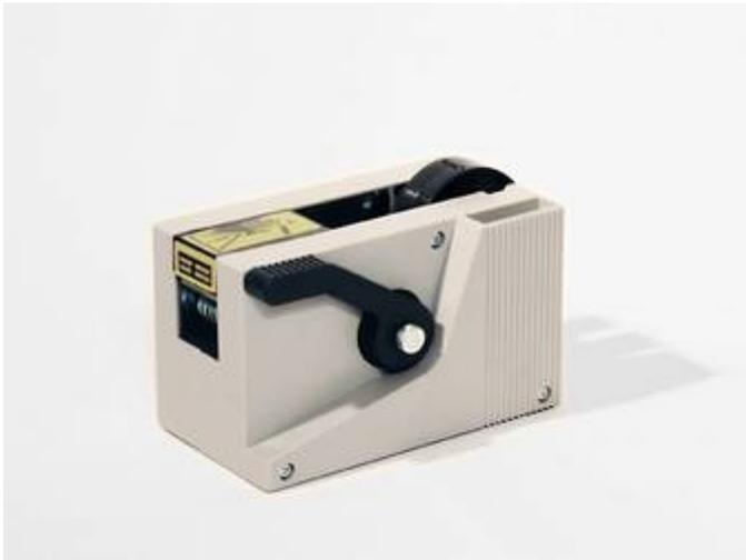
Halbautomatisches, standfestes und formschönes Abrollgerät mit Längeneinstellung. Mit einem Hebelzug lassen sich max. 110mm ablängen. Durch mehrmaliges Betätigen des Handhebels kann unendlich lang gespendet werden, bevor das Band durch einfaches Entnehmen am sehr scharfen Obermesser abgetrennt wird.
